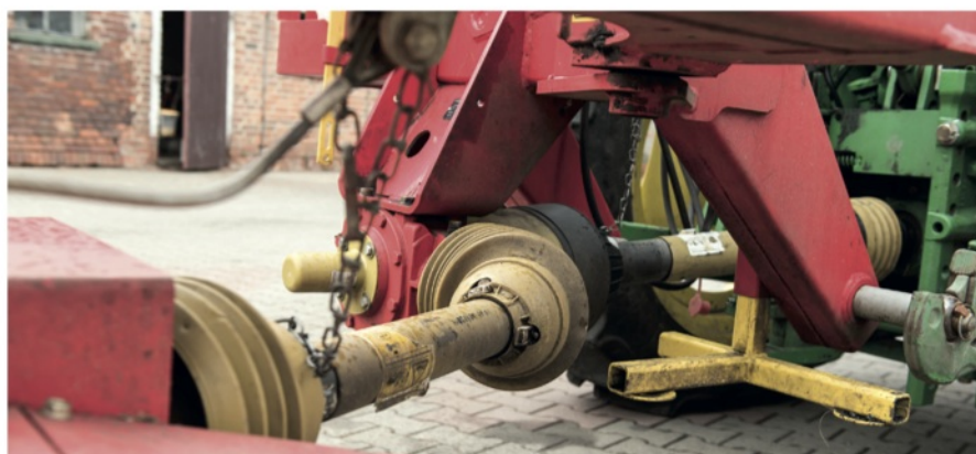
Podczas gdy obroty WOM sięgają 540 na min, silnik ciągnika pracuje z 1500 obr./min, co pozwala na ekonomiczną pracę.
